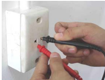
รูปภาพ ลักษณะการวัดแรงดันไฟฟ้าเอซี
