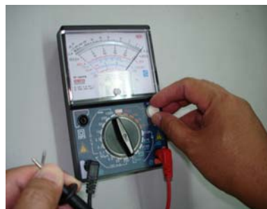
รูปภาพการปรับ 0 โอห์มก่อนวัดค่าความต้านทาน
