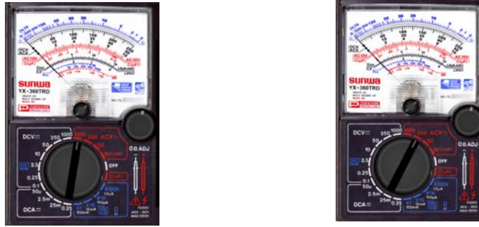
รูปการตั้งสวิทช์เลือกการวัดแรงดันไฟฟ้ากระแสสลับ ACV
