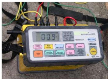
รูปที่ 2.48 ตัวอย่างเครื่องวัดค่าความต้านทานการต่อลงดิน
