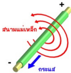
รูปที่ ๒.๑๗ เส้นแรงแม่เหล็กรอบตัวนำที่มีกระแสไฟฟ้าไหลผ่าน
