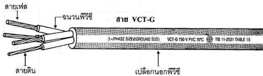
(ค) สายอ่อนหุ้มด้วยฉนวนและเปลือก หลายแกน มีสายดิน 750 V 70°C ตารางที่ 15
