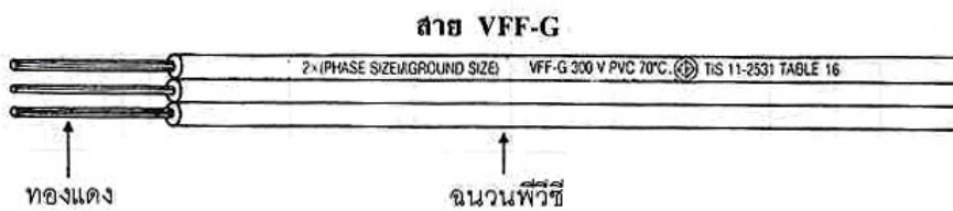
(ณ) สายแบนคู่ มีสายดิน 300 V 70°C ตารางที่ 16
