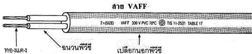
(ด) สายอ่อนแบน 2 แกน และ 3 แกน 300 V 70°C ตารางที่ 17
