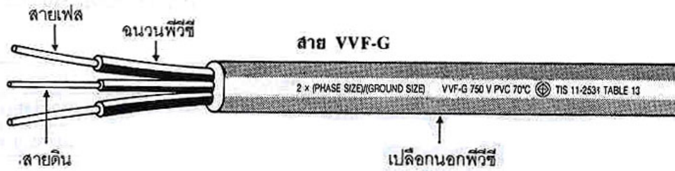
(จ) สายแบน 2 แกน มีสายดิน 750 V 70°C ตารางที่ 13
