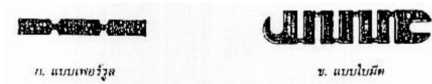
รูปที่ 7-11 เส้นฟิวส์สำหรับคาร์ทริดจ์ฟิวส์
